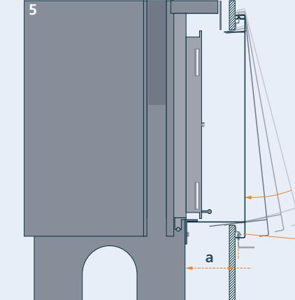
**nota bene** : le corps du foyer doit être installé à une distance de 155 à 160 mm (**a**) du mur extérieur.
